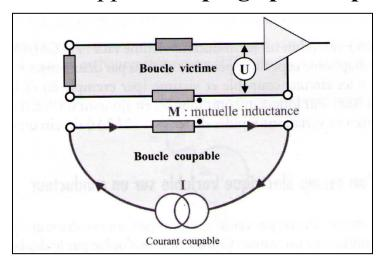
Tension induite dans la boucle victime :  $U=M\Delta I/\Delta t$   $U=2\pi fMI$
